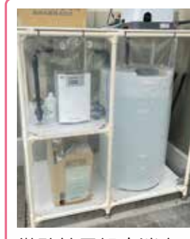
微酸性電解水消毒 有効塩素濃度10~30mg/kgの高い殺菌力を有した酸性水を使用し、介護機器の細部まで汚れを洗い落とします。
