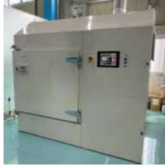
マットレス乾燥機 ※湿熱循環運転方式で効率よく乾燥します。
